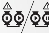
Una bomba funciona constantemente. La bomba de reserva se pone en marcha cada cierto tiempo para evitar que se bloquee. Si la bomba en funcionamiento se detiene debido a un fallo, la bomba de reserva se pone en marcha automáticamente.
