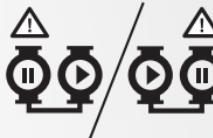
Un circulateur fonctionne en continu. Le circulateur de secours fonctionne de temps en temps pour éviter tout grippage. Si le circulateur en service s'arrête en raison d'une panne, le circulateur de secours prend le relais automatiquement.
