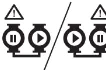
Una pompa è in funzione continuamente. La pompa di backup viene azionata a intervalli per evitare il grippaggio. Se la pompa in servizio si arresta a causa di un guasto, la pompa di backup si avvierà automaticamente.
