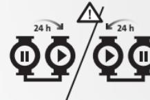
Una bomba funciona constantemente. La bomba de reserva se pone en marcha periódicamente para evitar su agarrotamiento. Si la bomba en servicio se detiene debido a un fallo, la bomba de reserva se pone en marcha automáticamente.
