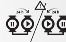
Una pompa è in funzione. La pompa di riserva viene accesa sporadicamente per evitarne il grippaggio. Se la pompa in servizio si arresta a causa di un guasto, la pompa di riserva si avvierà automaticamente.
