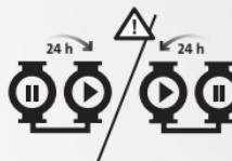
Un circulateur fonctionne en continu. Le circulateur de secours fonctionne de temps en temps pour éviter tout grippage. Si le circulateur en service s'arrête en raison d'une panne, le circulateur de secours prend le relais automatiquement.
