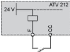
Position "PLC" avec sorties transistor de l'automate
