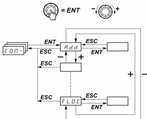
只有在停止了变频器并且没有运行命令的情况下才能修改这些参数。直到关闭并再次启动变频器后，修改的 [Modbus 地址] (Add)，[Modbus 波特率] (tbr)，[Modbus 格式] (tFO)，[CANopen 地址] (AdCO) 和 [CANopen 波特率] (bdCO) 参数才会生效。在可选的 ATV31 远程显示终端上，可以在开关处于  位置的时候访问此菜单。
