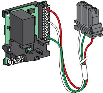
Pour l'installation du module de commutation ERMS ESM, contactez votre agent de maintenance sur site Schneider Electric.
