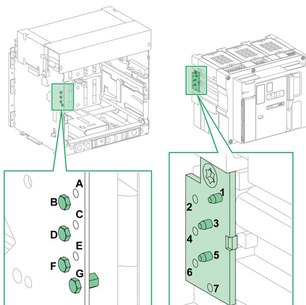
La combinaison sélectionnée sur le châssis doit correspondre à celle choisie sur l'appareil (voir le tableau suivant). Par exemple, la combinaison ABCD sur le châssis correspond à la combinaison 567 sur l'appareil.
