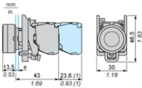
e : épaisseur du dispositif de serrage : 1 à 6 mm / 0,04 à 0,24 pouce
