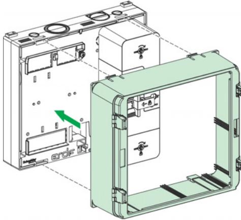
Clipsage de l'habillage par quatre points sur le panneau de contrôle.
