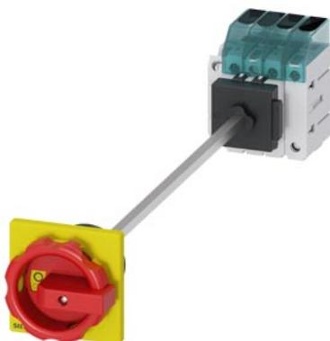
Interrupteur-sectionneur 3LD3, Iu 25 A Interrupteur général 3 pôles + N puissance assignée d'emploi avec 23 A CA pour 400V 9,0 kW Fixation au sol Interrupteur de base avec commande de porte fixation centrale 22,5 mm Commande rotative rouge/jaune 66 x 66 mm avec interrupteur auxiliaire 1NF+NO
