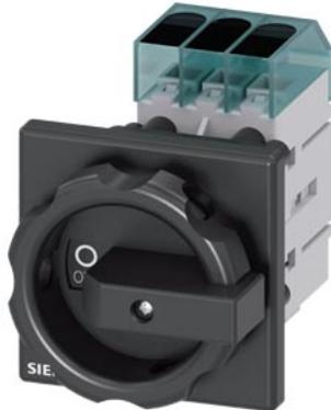
Interrupteur-sectionneur 3LD3, Iu 63 A Interrupteur général 3 pôles puissance assignée d'emploi avec 23 A CA pour 400V 22,0 kW fixation à l'avant Interrupteur de base avec fixation centrale 22,5 mm Commande par manette noire 66x66 mm
