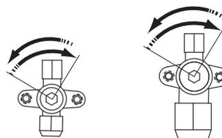
Dans le sens inverse des aiguilles d'une montre pour ouvrir.
