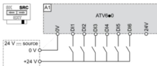
**Réglez le commutateur sur la position SK (Collecteur), en utilisant la sortie d'alimentation pour les entrées numériques**
