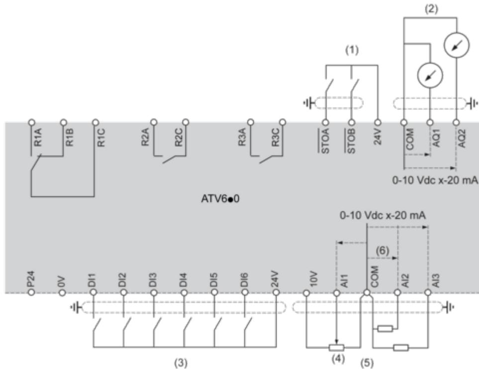
**Raccordement des capteurs**
