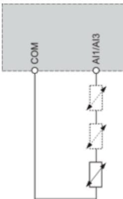
Il est possible de raccorder 1 ou 3 capteurs sur les bornes AI1 ou AI3
