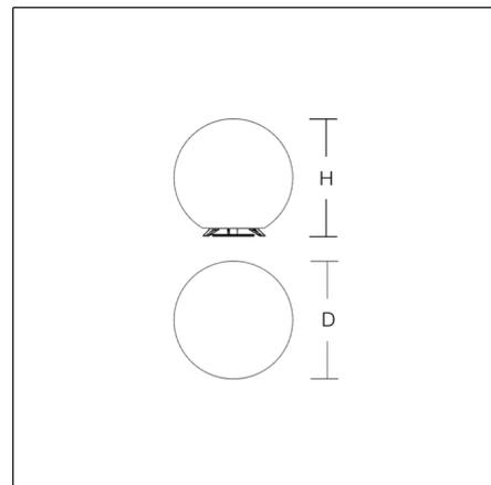
Luminaria decorativa para exterior. Esfera flotable con base plana. Soporte base de material sintético. Difusor esférico de material sintético (polietileno), opalino satinado mate. LED con secuenciador de cambio de colores (servicio con baterías) - color de la luz regulable RGB o blanco. Incluido mando a distancia. Tiempo de servicio: máx. de 8 a 12 horas (servicio continuo). Incluido cargador externo DC 7,5 V / 600 mA. Cargar exclusivamente en lugares secos.
