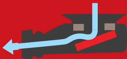
L'eau de la douche exerce une pression supérieure à la force magnétique des aimants. Le clapet magnétique mobile s'ouvre pour permettre l'écoulement. Plus le débit de l'eau augmente au cours de la douche, plus le clapet mobile s'ouvre.
