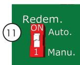
Pour que la pompe redémarre automatiquement après la détection d'un défaut (marche à sec, manque d'eau, surcharge), positionner l'interrupteur de redémarrage (11) sur « Auto ».
