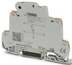
Protection antisurtension précise avec indicateur d'état intégré pour un fil de signal avec potentiel de référence relié à la terre. Utilisable dans des circuits sécurisés jusqu'à la catégorie SIL 3.
