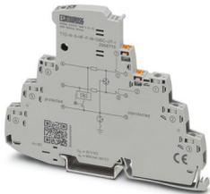
Protection antisurtension avec indicateur d'état intégré et sectionnement par couteau pour trois fils de signaux à potentiel de référence commun. Pour applications HF et interfaces de télécommunication sans tension d'alimentation (jusqu'à 90 MBit/s). Mise à la terre indirecte via éclateur à gaz.
