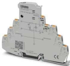
Parafoudre basse tension, avec indicateur d'état intégré et sectionnement par couteau pour un circuit de signalisation bifilaire libre de potentiel de terre, p. ex. boucle de courant 0(4)...20 mA, homologation EX e pour zone 2, compatible HART. Utilisable dans des circuits sécurisés jusqu'à la catégorie SIL 3.
