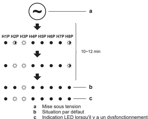
Si la situation par défaut ne s'affiche pas au bout de 10~12 minutes, vérifiez le code d'anomalie affiché sur l'interface utilisateur de l'unité intérieure. Résolvez le code de dysfonctionnement en conséquence. Vérifiez d'abord le câble de communication.
