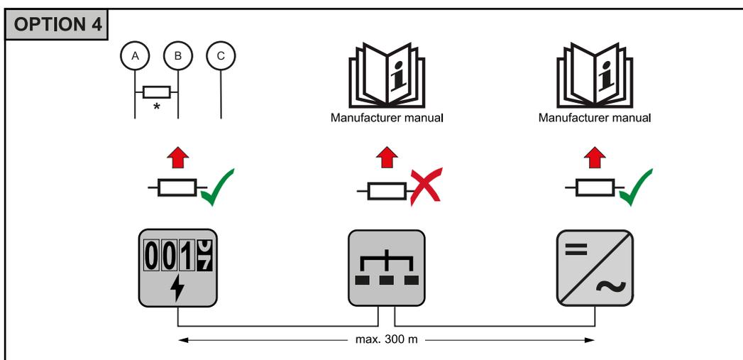
\* La résistance terminale du Fronius Smart Meter est établie entre **A** et **B**. Le Fronius Smart Meter présente une résistance terminale de R 120 Ohm.
