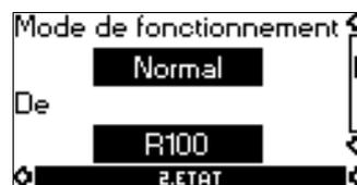
Cet affichage indique le mode de fonctionnement réel (Arrêt, Normal (régime) ou Max.). Il indique aussi le lieu de sélection du mode de fonctionnement (R100, Pompe, Bus, Externe ou Arrêt). Pour plus d'informations sur la fonction d'arrêt, voir paragraphe [10.3.5](#).
