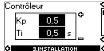
Le gain ( $K_p$ ) et le temps de fonctionnement complet ( $T_i$ ) du contrôleur PI intégré peut être réglé sur cet affichage si le réglage par défaut n'est pas le réglage optimal.
