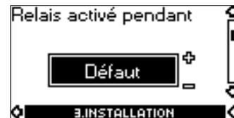
Sélectionner dans quelle situation le relais de signal doit être activé.
