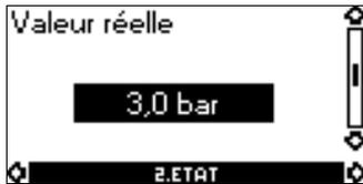
L'affichage indique la valeur réellement mesurée par le capteur connecté.
