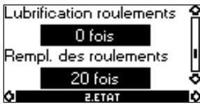
L'affichage indique combien de fois les roulements du moteur ont été lubrifiés et quand il faut les remplacer.
