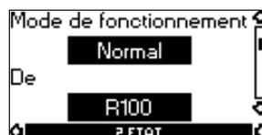
Cet affichage indique le mode de fonctionnement réel (*Normal* (régime), *Arrêt*, *Min.*, ou *Max.*). De plus, il indique comment le mode de fonctionnement a été sélectionné (*R100*, *Pompe*, *Bus* ou *Externe*).
