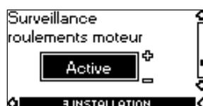
La fonction surveillance des roulements moteur peut être réglée sur ces fonctions :
