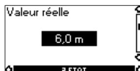
L'affichage indique la valeur réelle mesurée par un capteur connecté.
