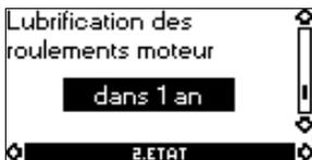
Cet affichage montre le délai de lubrification des roulements du moteur. Le contrôleur surveille le profil de fonctionnement de la pompe et calcule la période entre les lubrifications des roulements. Si le profil de fonctionnement change, le délai entre les lubrifications peut changer en fonction.
