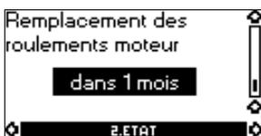
L'affichage indique le délai de remplacement des roulements du moteur. Le contrôleur surveille le profil de fonctionnement de la pompe et calcule la période entre les remplacements des roulements.
