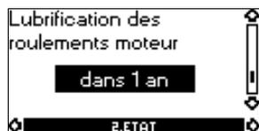
Cet affichage montre le délai de lubrification des roulements du moteur. Le régulateur surveille le profil de fonctionnement de la pompe et calcule le délai entre les lubrifications des roulements. En cas de modification du profil de fonctionnement, le délai calculé jusqu'à la prochaine lubrification peut aussi changer.
