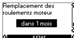
Cet écran indique à quel moment remplacer les roulements du moteur. Le régulateur surveille le profil de fonctionnement de la pompe et calcule le délai entre les remplacements des roulements.
