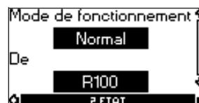
Cet affichage indique le mode de fonctionnement réel (Normal (service), Arrêt, Mini ou Maxi). Il indique aussi la source de sélection du mode de fonctionnement (R100, Pompe, Bus, Externe ou Arrêt). Pour plus d'informations sur la fonction d'arrêt (Arrêt), voir paragraphe [9.3.8 Fonction d'arrêt](#).
