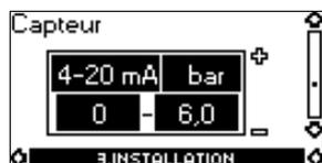
Le réglage du capteur est uniquement valable en cas de fonctionnement régulé.
