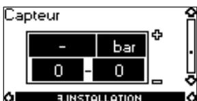
**Avec capteur de pression (régulé)**
