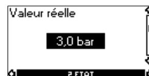
L'affichage indique la valeur réellement mesurée par le capteur connecté.
