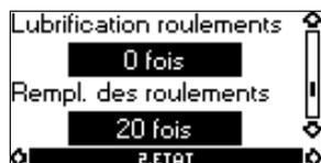
L'affichage indique combien de fois les roulements du moteur ont été lubrifiés et quand il faut les remplacer.
