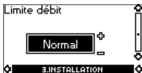
Pour régler à quel débit le système permute d'un fonctionnement continu avec une pression constante sur un fonctionnement marche/arrêt, sélectionner parmi ces 4 réglages parmi lesquels 3 sont préconfigurés pour des limites de débit :
