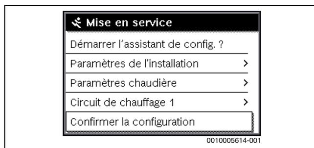
Fig. 50 Menu de mise en service - confirmer la configuration
