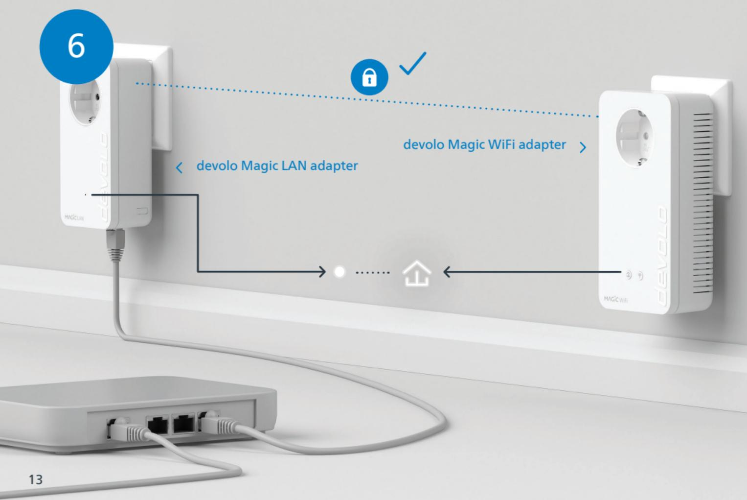
**| DE |** Der Vorgang ist abgeschlossen, sobald alle LEDs der Geräte permanent weiß leuchten. Dieser Vorgang dauert maximal 3 Minuten.
