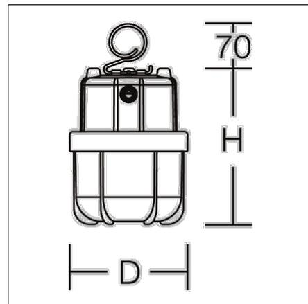
Kuppelleuchte. Schlag- und bruchfestes 2-Komponenten-Kunststoff-Gehäuse. Abdeckung opal, aus schlag- und bruchfestem Kunststoff (Polycarbonat). Homogene, weiche und blendreduzierte Ausleuchtung. Einklappbarer Aufhängehaken aus Edelstahl mit Fallsicherung. Als Pendelleuchte oder auf dem Boden stehend einsetzbar. Schwere Gummischlauchzuleitung H07RN-F für hohe mechanische Belastungen mit Netzstecker. Umfangreiches Zubehör optional erhältlich (Stative, Halteschienen, Magnethalter, etc.).
