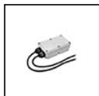
S.2496 DALI2 RELAY SWITCH pour ON-OFF (NON GRADABLES) 230V APPAREILS Tous les appareils fonctionnant à 230V non gradables (ON-OFF) peuvent être contrôlés ON-OFF avec le système DALI2 avec les accessoires interfaces suivants. Il s'en suit que l'appareil sera contrôlé à distance dans le seul mode ON-OFF et non pas en mode gradable. IP67 Max nominal load 1000VA Max switching current 8A Max inrush current 80A Dimensions 175,5mm x 86,5mm x 43mm La somme des courants d'appel des dispositifs à connecter à cette interface ne doit pas dépasser la valeur maximale tolérable de 80A.
