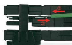
Toutes les connexions du distributeur sont directement verrouillées après l'enfichage pour éviter un démontage accidentel. Déverrouillage à l'aide d'un tournevis quel que soit le nombre et la position des connecteurs mâle/femelle.
