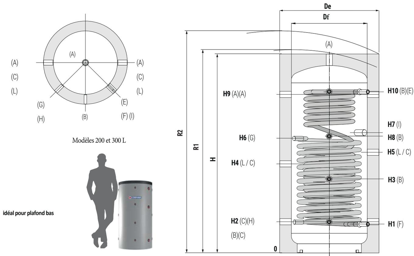
**A** Arrivée générateur / Départ chauffage/Purgeur 1"1/2 F
