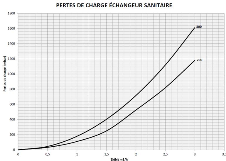
PERTES DE CHARGE ÉCHANGEUR SANITAIRE
