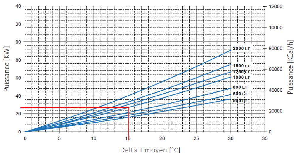
**Puissance échangée sur le serpentin acier supérieur**, en fonction de l'écart de température moyen entre primaire et accumulation (avec débit de 3 m<sup>3</sup>/h dans le serpentin).
