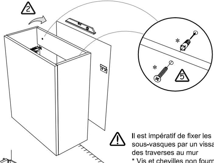
Il est impératif de fixer les sous-vasques par un vissage des traverses au mur
