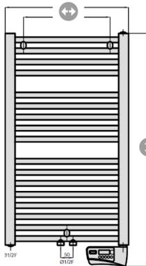
Équipé de 2 orifices centraux ( $\varnothing$  15/21) entraxe 50 mm, 1 orifice en bout collecteur gauche ( $\varnothing$  15/21) et purgeur d'air à jet orientable ( $\varnothing$  15/21).
