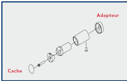
4 fixations positionnables entre les tubes et réglables pour un montage parfait.
