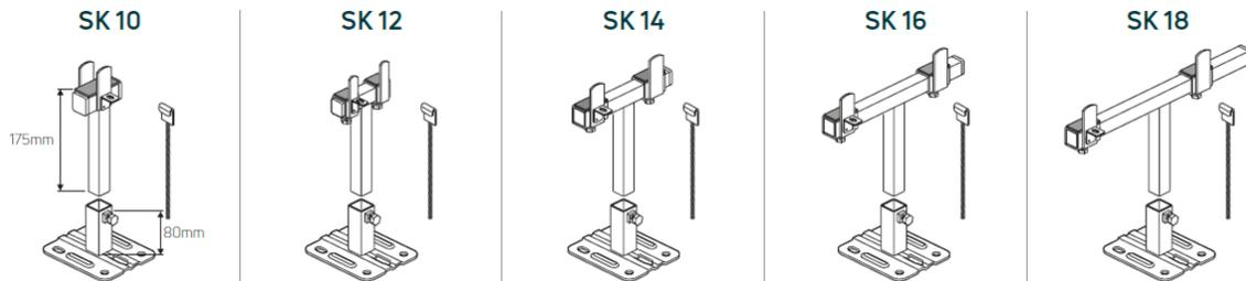
PIEDS SUPPORT SK : MODÈLES PLINTHES (HAUTEURS JUSQU'À 286 MM)
