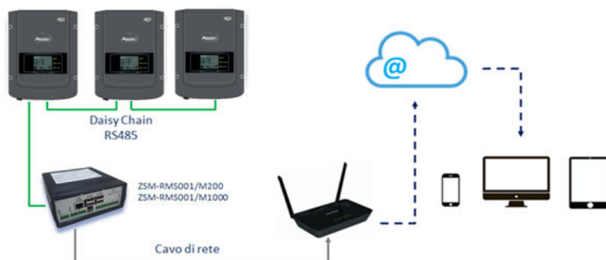
Figure 77 – Schéma illustrant le fonctionnement du datalogger ZSM-RMS001/M200 / ZSM-RMS001/M1000
