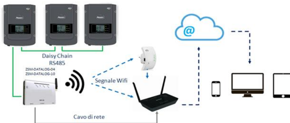
Figure 76 – Schéma de connexion du datalogger ZSM-DATALOG-04 / ZSM-DATALOG-10
