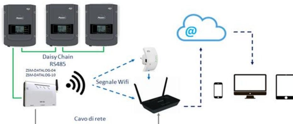
Figure 76 – Schéma de connexion du datalogger ZSM-DATALOG-04 / ZSM-DATALOG-10
