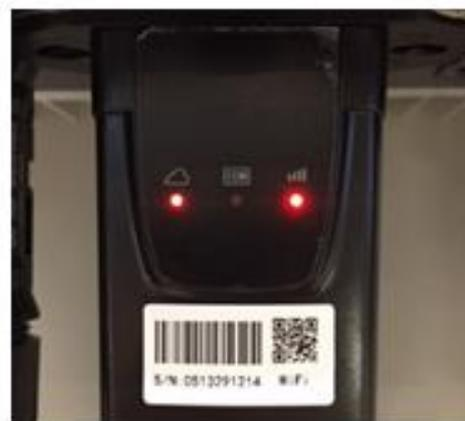
Figure 66 – État de communication irrégulière entre onduleur et Wi-Fi
