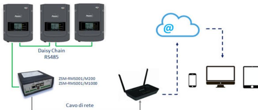
Figure 86 – Schéma fonctionnel du datalogger ZSM-RMS001/M200 / ZSM-RMS001/M1000
