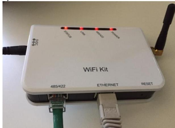
Figure 93 – Câble Ethernet connecté au datalogger
