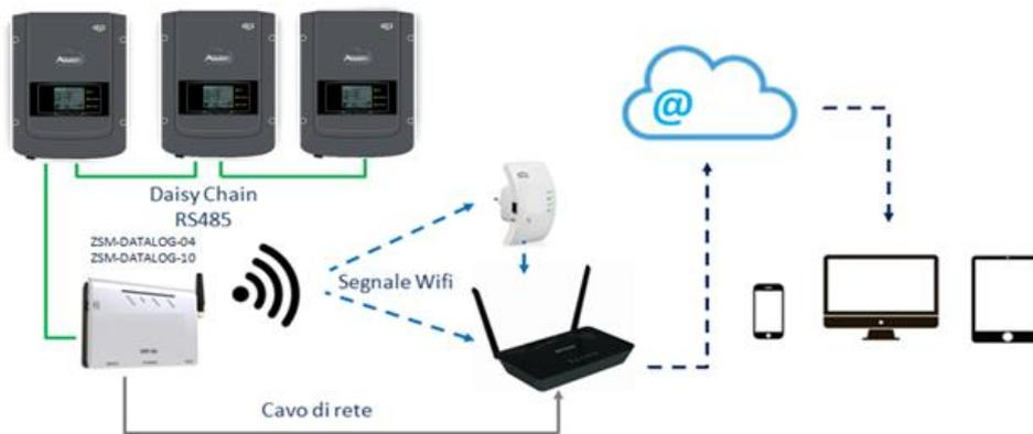
Figure 85 – Schéma de connexion du datalogger ZSM-DATALOG-04 / ZSM-DATALOG-10
