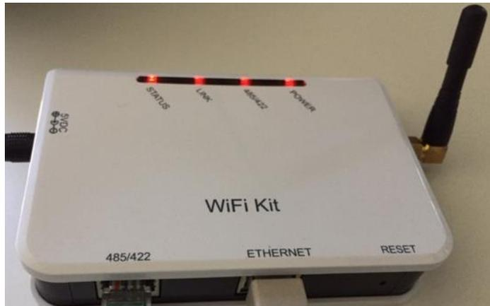
Figure 106 – Led qui indiquent la configuration correcte du datalogger
