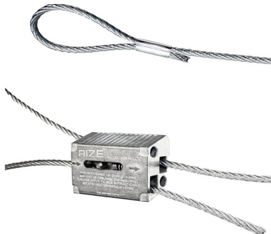
Notre kit de suspension est composé d'un Zip-clip (auto-bloquant et sans clé de réglage) et d'un câble avec embout boucle sertie. Il mesure 2,00m de longueur pour 1,5mm de diamètre. Avec un poids de 25kg, il est conçu aussi bien pour l'intérieur que pour l'extérieur.
