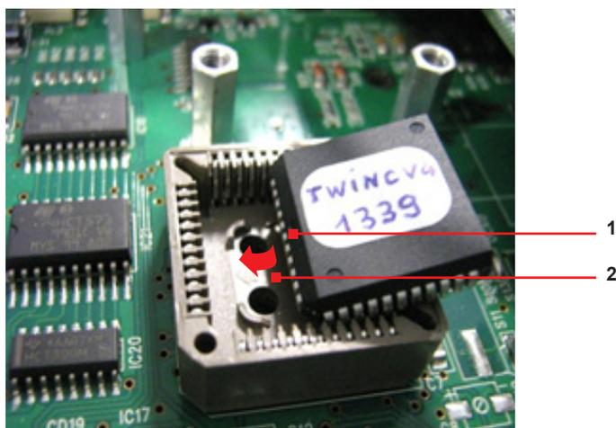
**Un des côtés du micro est marqué par un point (indiqué par 1). Il faut que la flèche du support (indiquée par 2) soit du même côté que le point.**
