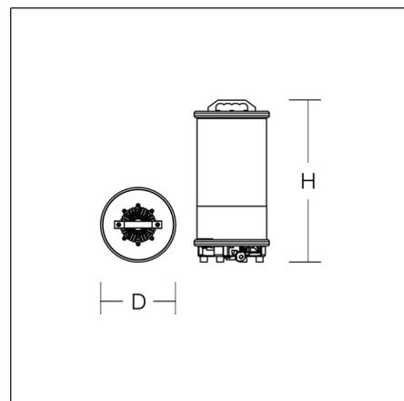
Luminaire grande surface. Corps en aluminium traité époxy. Socle en acier, revêtu par poudre, avec pieds en caoutchouc. Couvercle opale, en plastique (polycarbonate) résistant aux chocs et aux impacts. Éclairage homogène, doux et peu éblouissant. Utilisable sur trépied, comme lampe de sol ou suspendue. Support pour tourillon de trépied d=30mm, DIN 14640. Interrupteur inverseur (arrêt, éclairage à 180°, éclairage à 360°). Sac de transport inclus.
