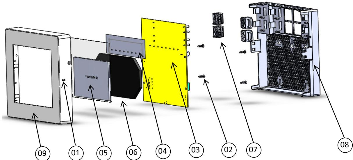
① Si le boîtier est clipsé, déclipser le en appuyant dans les 2 fentes à l'aide d'un tournevis plat
