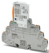
Parafoudre basse tension comprenant une fiche de protection et un élément de base, à indicateur d'état intégré, destiné à un circuit de signalisation à 3 fils libre de potentiel de terre, à intensité nominale élevée, homologation EX e pour zone 2, compatible HART. Utilisable dans des circuits sécurisés jusqu'à SIL 3.
