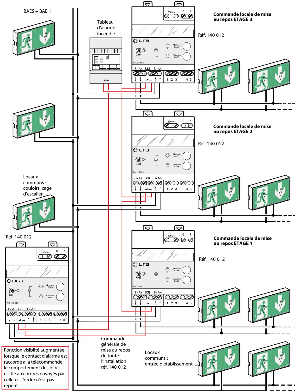
Fonction visibilité augmentée : lorsque le contact d'alarme est raccordé à la télécommande, le comportement des blocs est lié aux ordres envoyés par celle-ci. L'ordre n'est pas répété.
