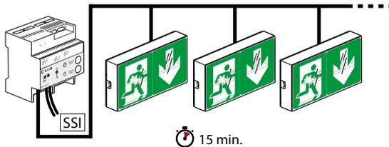
**Nota:** Il est possible d'arrêter le mode visibilité augmente quand la boucle SSI est refermée par deux appuis successifs sur la touche "Extinction" des télécommandes réf. 140 012.
