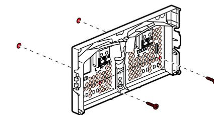
Fixation possible sur boîte d'encastement Ø 60 :
