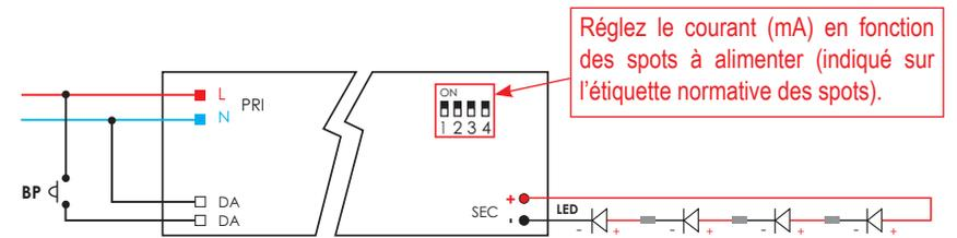
Raccorder vos spots en série sur l'entrée secondaire du convertisseur (SEC + et -), puis raccorder le Neutre (N) et la Phase (L).
