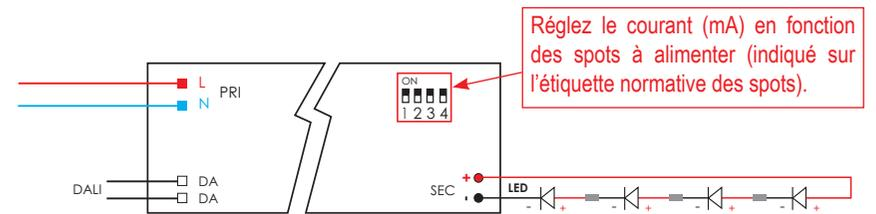
Raccorder vos spots en série sur l'entrée secondaire du convertisseur (SEC + et -), puis raccorder votre commande DALI entre les 2 entrées DA. Raccorder le Neutre (N) et la Phase (L).
