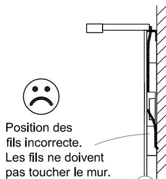
Position des fils incorrecte. Les fils ne doivent pas toucher le mur.
