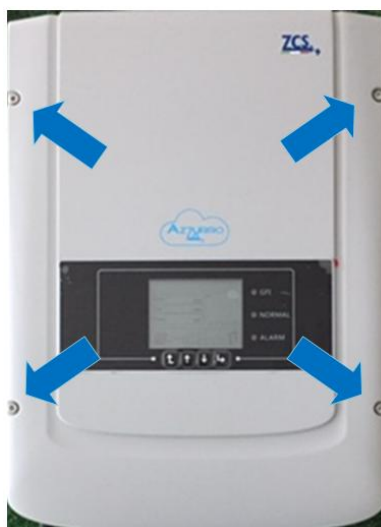
Figure 1 – Position des quatre vis à six pans creux pour la fixation du capot avant
