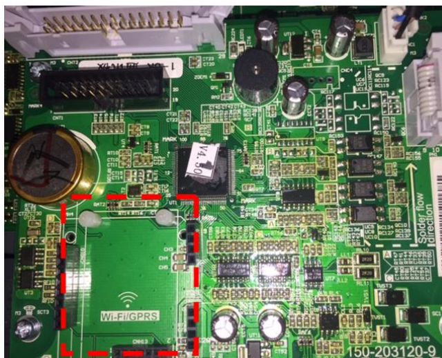
Figure 3 – Position du logement de la carte Wi-Fi sur la carte de communication
