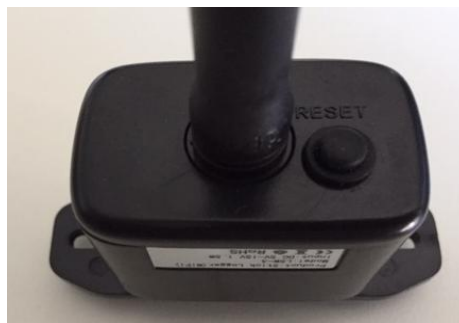
Figure 40 – Touche de réinitialisation sur la carte Wi-Fi
