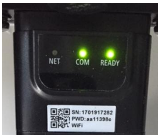
Figure 69 – État de communication irrégulière entre adaptateur et serveur à distance
