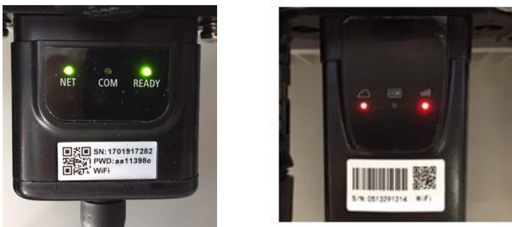
Figure 57 – État de communication irrégulière entre onduleur et Wi-Fi
