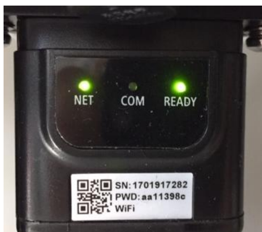
Figure 68 – État de communication irrégulière entre onduleur et adaptateur
