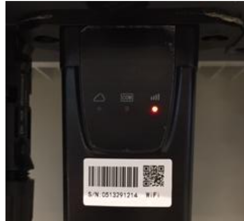
Figure 59 – État de communication irrégulière entre Wi-Fi et serveur à distance
