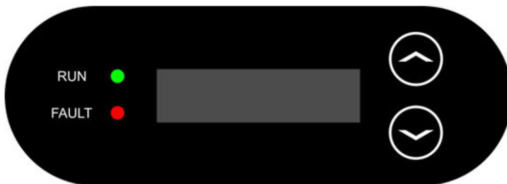
Figure 36 – Écran LCD avec touches et indicateurs LED
