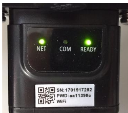
Figure 74 – État de communication irrégulière entre onduleur et adaptateur
