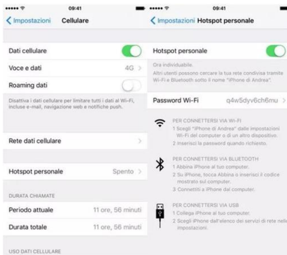
Figure 61 – Configuration d'un smartphone iOS en tant que routeur Hotspot
