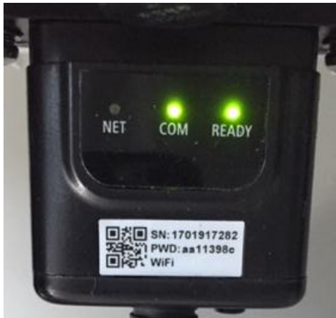
Figure 59 – État de communication irrégulière entre Wi-Fi et serveur à distance
