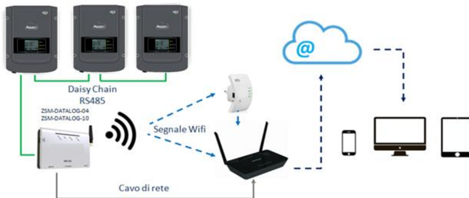
Figure 76 – Schéma de connexion du datalogger ZSM-DATALOG-04 / ZSM-DATALOG-10
