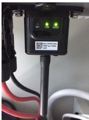
Figure 54 – État initial des LED
