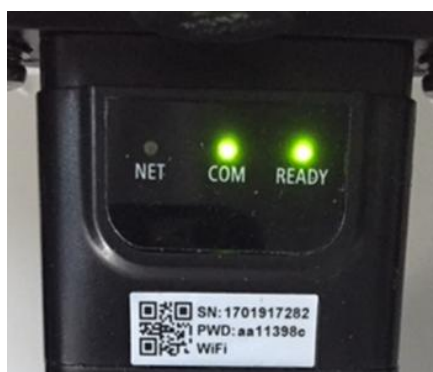
Figure 75 – État de communication irrégulière entre adaptateur et serveur à distance
