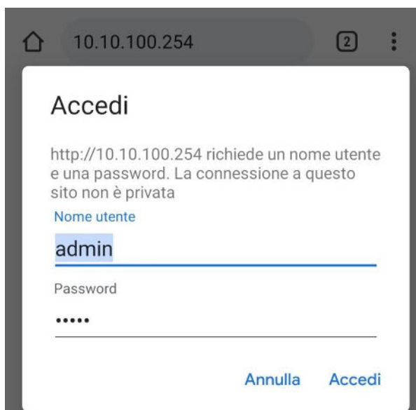
Figure 90 - Page d'accès au serveur Web pour configurer le datalogger
