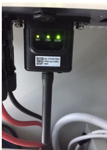
Figure 55 – État final des LED
