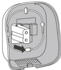
Przełożyć moduł zasilający termostatu przez otwór w tylnej części termostatu.
