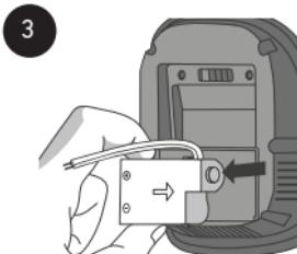
Wyjąć moduł zasilający z przedniej części termostatu.
