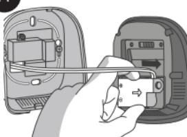
Κουμπώστε το τροφοδοτικό του θερμοστάτη ιο στην πρόσοψη του θερμοστάτη.
