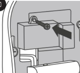
Volver a colocar y atornillar la cubierta de protección de la regleta de bornes.
