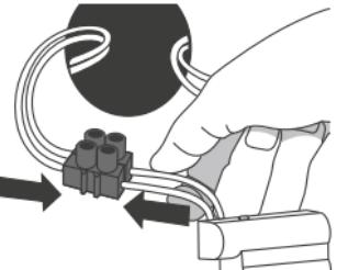
Relier les câbles du module d'alimentation du thermostat aux câbles d'alimentation qui sortent de la boîte d'encastrement à l'aide d'un connecteur approprié.
