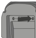
Si vous ne réalisez pas l'appairage dans cet intervalle de temps, à l'aide d'une pointe appuyez pendant 10 secondes sur le bouton PROG au verso de la face avant du thermostat. Veillez à ce que le module d'alimentation reste bien en place en retirant la face avant du thermostat.
