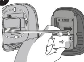
Clipper le module d'alimentation du thermostat io dans la face avant du thermostat.
