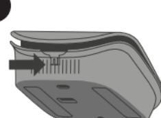
Desenganchar la cara delantera de la cara trasera presionando en el punto de presión.
