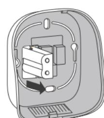
Hacer pasar el módulo de alimentación del termostato a través del orificio de la parte trasera del termostato.
