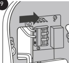
Εισαγάγετε και κουμπώστε τα καλώδια στις εξόδους NO και COM του μπλοκ ακροδεκτών αυτόματου κουμπώματος (χωρίς πολικότητα).
