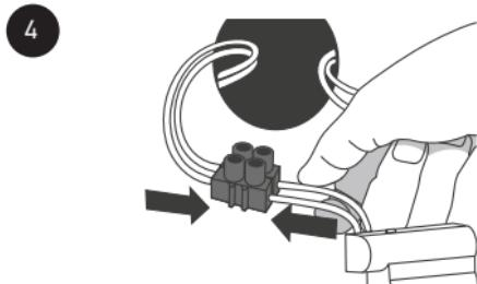
Pomocí vhodného konektoru propojte kabely napájecího modulu termostatu s napájecími kably vedoucími ze zapuštěné jednotky.
