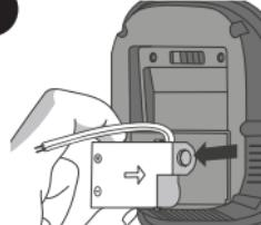
Retirar el módulo de alimentación de la cara delantera del termostato.
