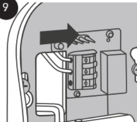
Insérer et clipper les câbles sur les sorties NO & COM du bornier à clip automatique (pas de polarité).
