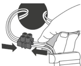
Połączyć przewody modułu zasilającego termostatu z przewodami zasilającymi, które wychodzą ze skrzynki mocującej za pomocą odpowiedniego złącza.
