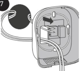
Faire passer les câbles de commande de la chaudière (NO / COM) à travers la face arrière.
