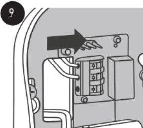
Vložte a připněte kabely k výstupům NO a COM svorkovníku s automatickou sponou (polarita není rozlišována).
