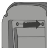
Se l'abbinamento non viene eseguito entro tale intervallo di tempo, servirsi di un oggetto appuntito per premere il pulsante PROG per 10 secondi sul retro del lato anteriore del termostato. Verificare che il modulo di alimentazione resti saldamente in posizione durante lo smontaggio del lato anteriore del termostato.
