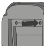
Si no lleva a cabo el emparejamiento en este intervalo de tiempo, presione con un objeto puntiagudo durante 10 segundos el botón PROG en el reverso de la cara delantera del termostato. Compruebe que el módulo de alimentación esté bien colocado retirando la cara delantera del termostato.
