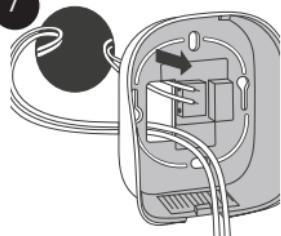
Περάστε τη μονάδα τροφοδοσίας του θερμοστάτου μέσα από την οπή στο πίσω μέρος του θερμοστάτου.
