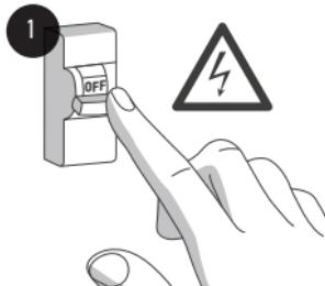
Před zahájením montáže termostatu vypněte elektrické napájení.
