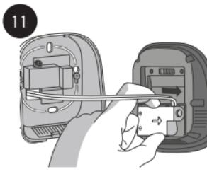
Připněte modul napájení termostatu io na přední stranu termostatu.
