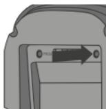
Findet das Pairing nicht in diesem Zeitraum statt, kann mit einem spitzen Gegenstand 10 Sekunden lang die PROG -Taste hinten am Frontteil des Thermostaten gedrückt werden. Achten Sie darauf, dass das Netzteil sicher in Position bleibt, wenn das Frontteil des Thermostaten abgenommen wird.
