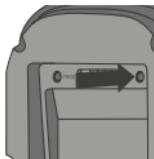
Pokud spárování neprovedete v tomto časovém intervalu, stiskněte pomocí tenkého hrotu na 10 vteřiny tlačítko PROG na zadní straně čelního panelu termostatu. Sejmutím čelního panelu termostatu zkонтrolujte, zda je napájecí modul na svém místě.
