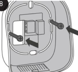
Fijar la cara trasera del termostato con los tornillos de la caja empotrada.
