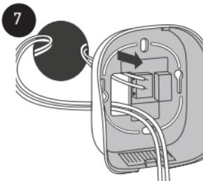
Far passare i cavi di comando della caldaia (NO / COM) tramite il lato posteriore.
