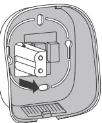
Faire passer le module d'alimentation du thermostat à travers l'orifice de la face arrière du thermostat.
