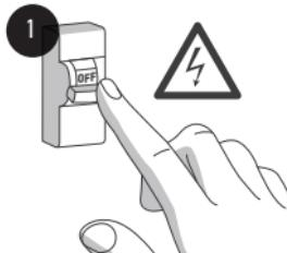
Odłączyć zasilanie przed rozpoczęciem instalacji termostatu i o.
