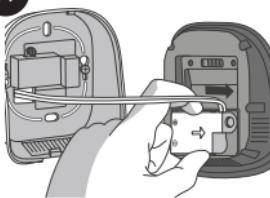
Encajar el módulo de alimentación del termostato en la cara delantera del termostato.
