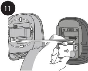
Wpisać moduł zasilający termostatu io w przednią część termostatu.
