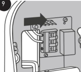
Introducir y fijar los cables a las salidas NA y COM de la regleta de bornes de clip automático (sin polaridad).
