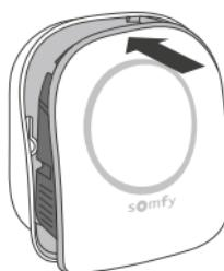
Repousser les câbles au maximum dans la boîte d'encastrement avant de clipper la face avant.
