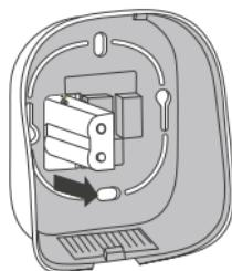
Far passare il modulo di alimentazione del termostato attraverso l'apertura sul retro del termostato.
