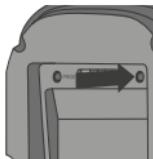
Jeśli powiązanie nie zostanie wykonane w tym przedziale czasu, naciśnąć przez 10 sekundy ostro zakończonym przedmiotem na przycisk PROG na odwrotnej stronie przedniej części termostatu. Pamiętać, aby moduł zasilania pozostał na swoim miejscu przy zdejmowaniu przedniej części termostatu.
