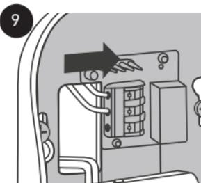
Włożyć i zacisnąć przewody na wyjściach NO i COM listwy zacisków automatycznych (bez polaryzacji).
