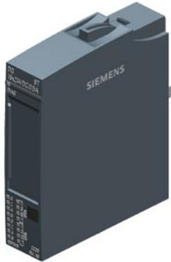
SIPLUS ET 200SP DQ 16x24VDC/0,5A ST basé sur 6ES7132-6BH01-0BA0 avec Conformal Coating, -40...+70°C, module de sortie TOR, convient pour BU de type A0, code de couleur CC00, diagnostic de module
