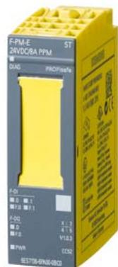
SIMATIC DP, POWER MODULE F-PM-E PPM PROFIsafe, pour ET 200SP; 24V CC coupure sûre de DQ et F-DQ jusqu'à PL D/SIL2 resp. PL E/SIL3 2 pour entrées TOR sûres 1 pour sorties TOR plus sûres PPM
