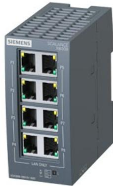
SCALANCE XB008 unmanaged Industrial Ethernet Switch pour 10/100 Mbit/s; pour le montage de petites structures en étoile et et structures linéaires ; diagnostic LED, IP20, AC/DC 24V alimentation, avec 8x paires torsadées 10/100 Mbit/s ports avec prise RJ45; manuel disponible en téléchargement .
