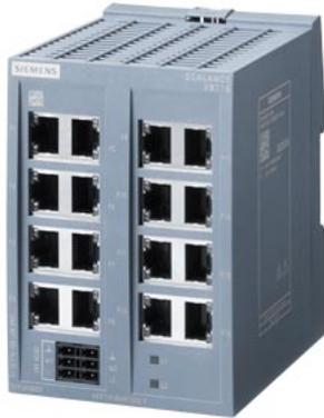
SCALANCE XB116 unmanaged IE Switch, 16x 10/100 Mbit/s ports RJ45; pour le montage de petites structures en étoile et et structures linéaires ; diagnostic LED, IP20, alimentation redondante, AC/DC 24V manuel disponible en téléchargement .
